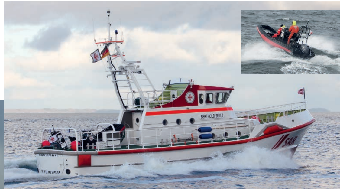
Die BERTHOLD BEITZ ist der neue 20-Meter-Seenotrettungskreuzer auf der Station Greifswalder Oie. Ihr Arbeitsboot ELSE (kleines Bild) ist erstmals ein robustes Vollkunststoffboot ohne Schlauch.
